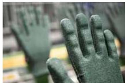
Der uvex Handschuh wird auf speziellen 3D-Ergo-Formen nach dem Vorbild der Natur vorgeformt
